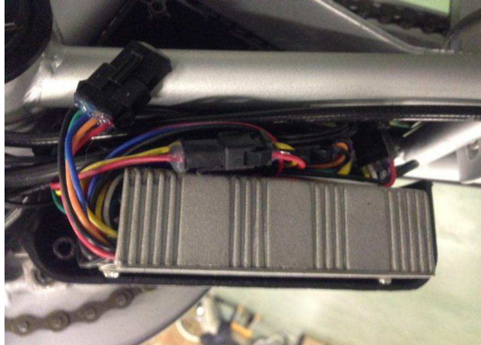
③-4 コントロールケースの開け方 コントロールケース内部
