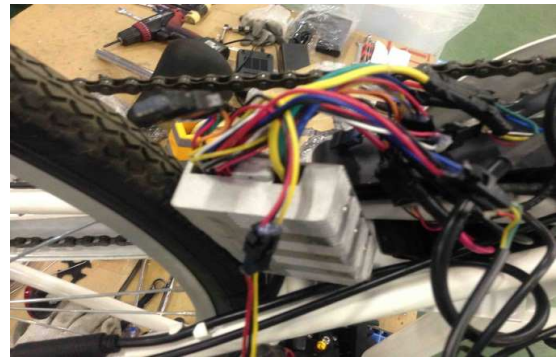
③-5 コントロールケースの開け方 ケーブル類を取り出してください
