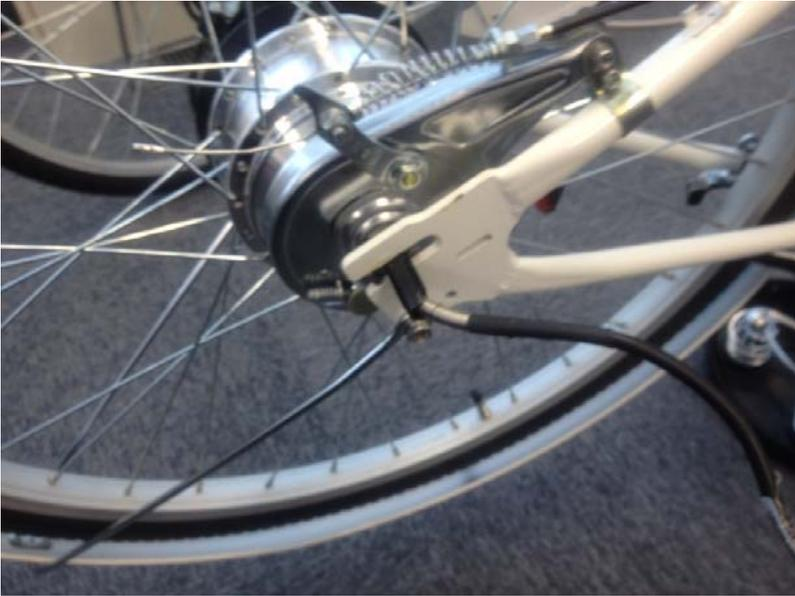
⑥ ブレーキワイヤーネジとブレーキ固定のネジを外します
