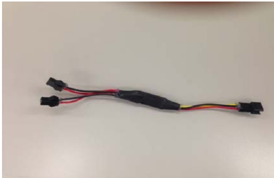
⑤-2 ケーブル交換 結束されている所はカットし、それ以外のカバーは ずらすと外せます。
