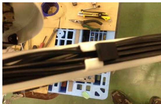
⑤-2 ケーブル交換 結束されている所はカットし、それ以外のカバーは ずらすと外せます。
